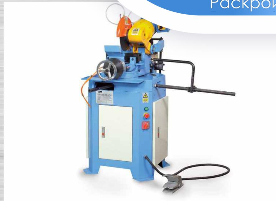
Станок дисковый отрезной
