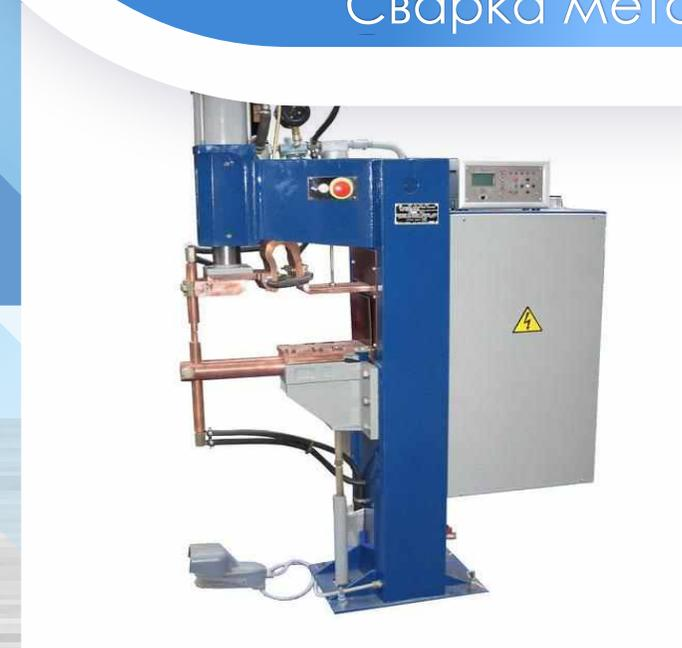
Машина контактной сварки
